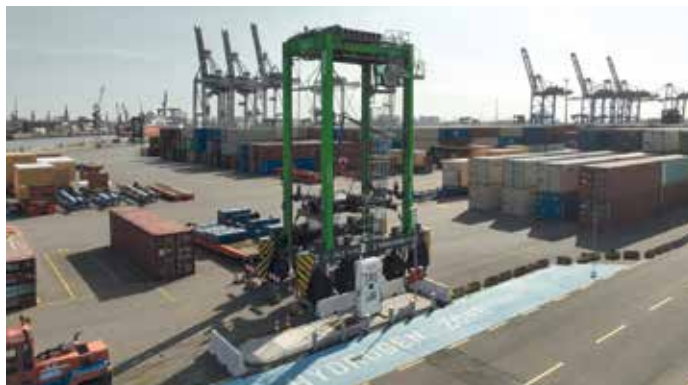
De praktijktests met de waterstofaangedreven Konecranes Noell Straddle Carrier in Hamburg leveren positieve eerste resultaten op.
