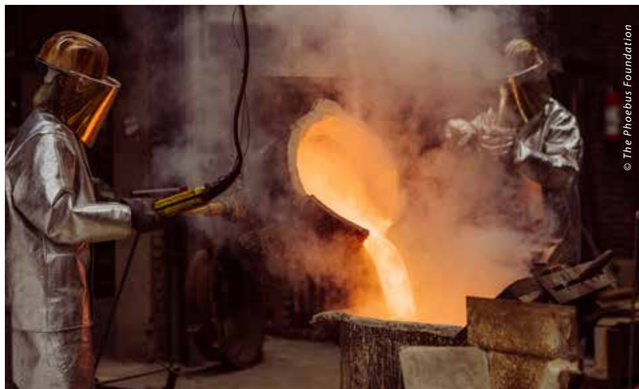
Het vloeibare brons wordt bij circa 1.100 °C in de klokvorm gegoten.
