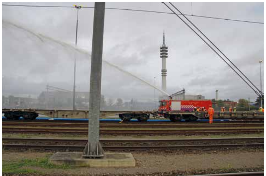
Worplengtetest brandweervoertuig emplacement.
