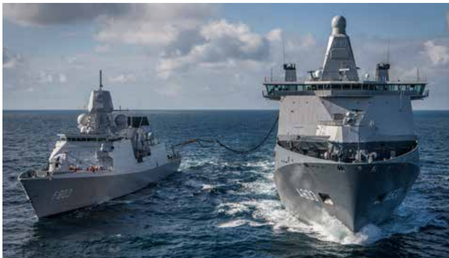
Een van de belangrijkste taken van Joint logistic Support Ship (JSS) Zr.Ms. Karel Doorman (links) is de bevoorrading van andere schepen op zee.
