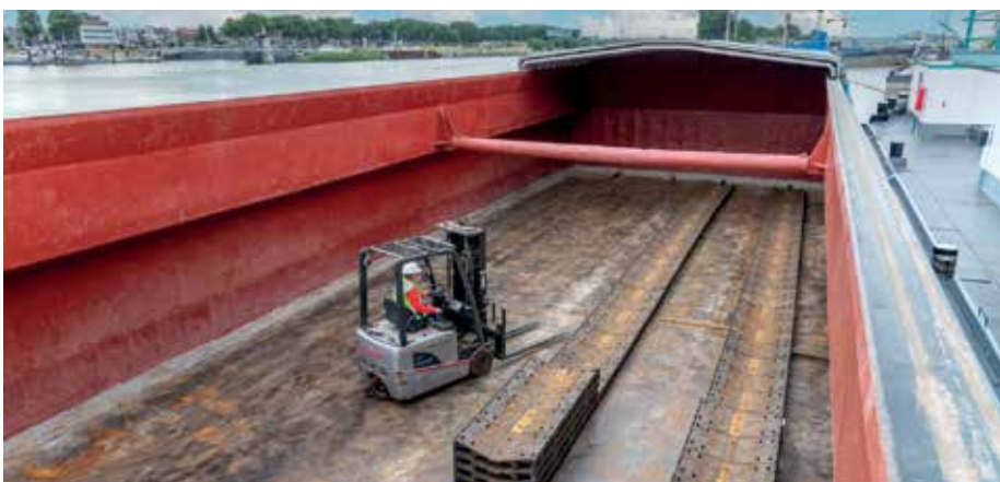
Het gebruiksvriendelijk rollengootsysteem Connected Coil Carrier (CCC) blijkt in de praktijk zeer effectief voor de binnenvaart.
