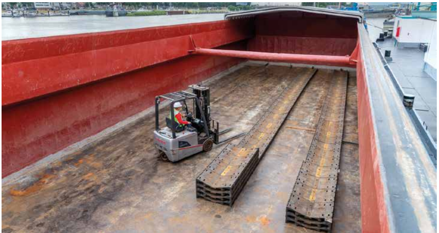
Het gebruiksvriendelijk rollengootsysteem Connected Coil Carrier (CCC) blijkt in de praktijk zeer effectief voor de binnenvaart.
