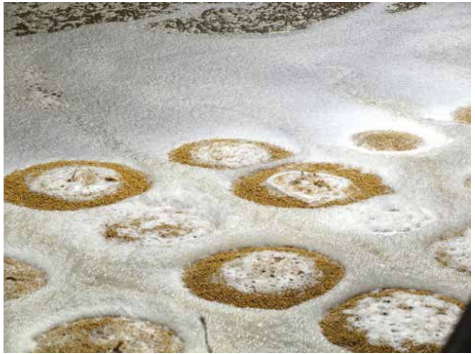
Maltproces, de gerst wordt in water geweekt en vervolgens aan de lucht blootgesteld.
