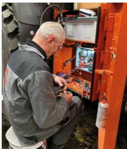
Elektrische aanpassing voor de nieuwste Hitachi ZW250-7 wiellader.
