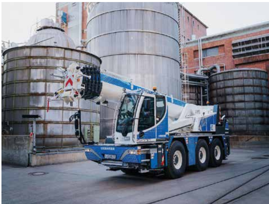
Mammoet heeft eind vorig jaar de eerste 50 tons elektrische hydraulische kraan aan haar vloot toegevoegd, de Liebherr LTC 1050-3.1E.
