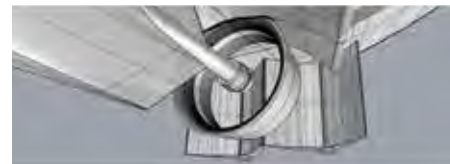
Animatie roer in achteruit stand. De stuwkracht in het nieuwe systeem van Shipfit blijft altijd bestaan en kan 360 graden gedraaid worden.
