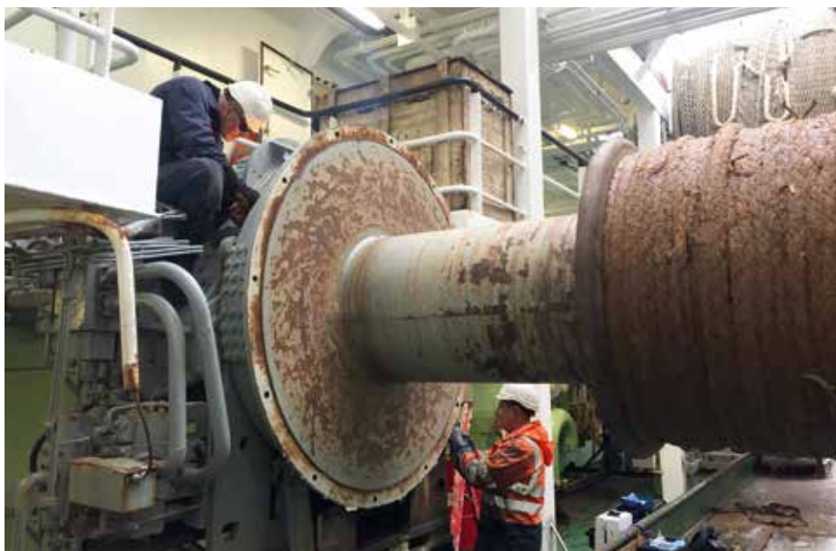
Reparatie aan een nettenlier vergt veel specifieke kennis waaronder die van hydraulische motoren.
