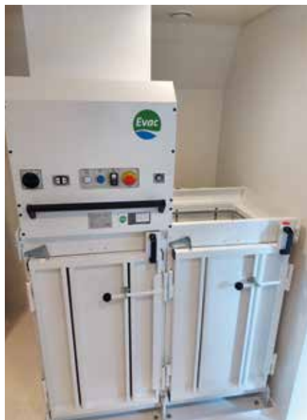
De Evac Compactor comprimeert karton en hard plastic aan boord van schepen.
