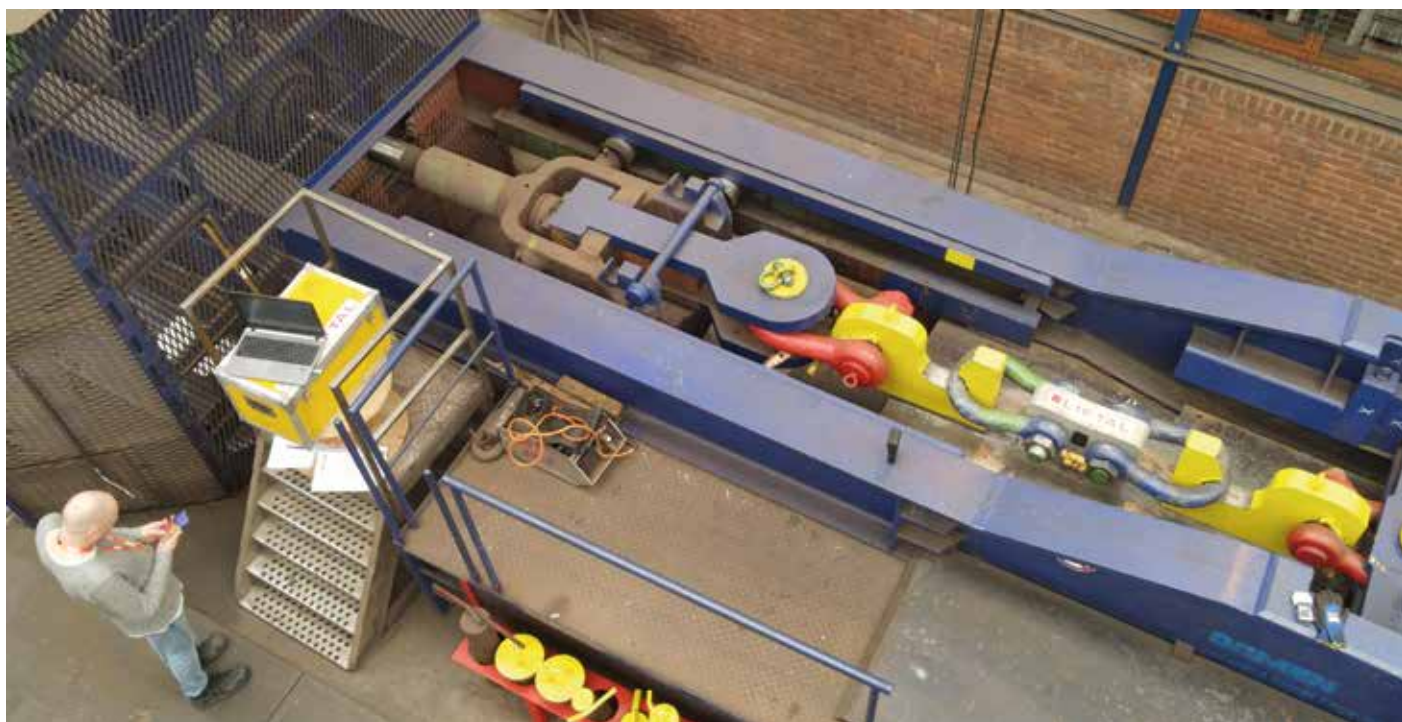
Het kalibreren van een loadcell.
