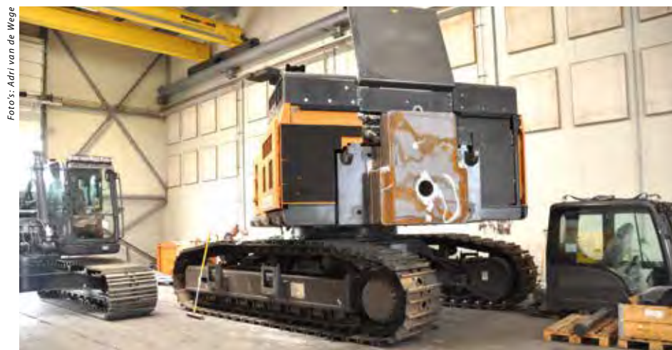
In de werkplaats worden allerlei aanpassingen aan standaard graafmachines verricht, zoals long-fronts, sloopgieken, kantelcabines en ballastverzwaringen.
