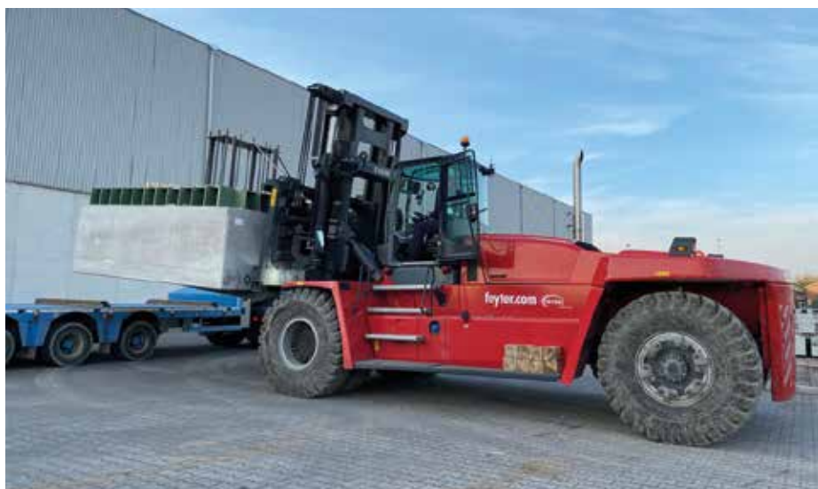
33 ton hefttruck in de betonindustrie, Vlissingen-Oost.
