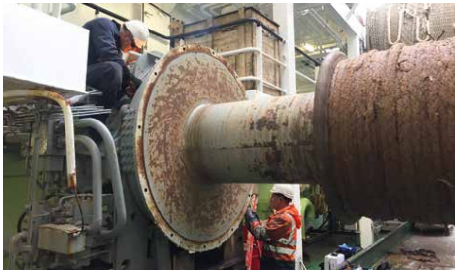
Reparatie aan een nettenlier vergt veel specifieke kennis waaronder die van hydraulische motoren.
