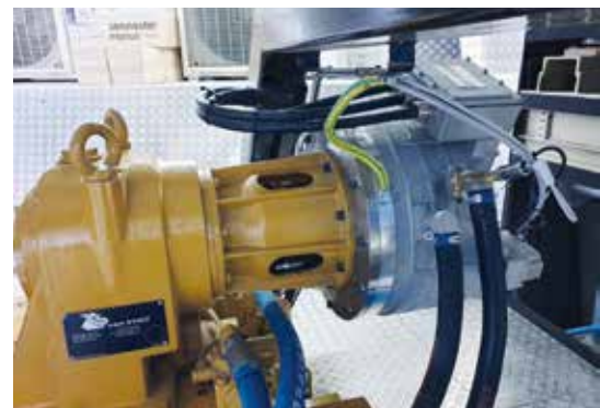
De nieuwste schepen in de vloot zijn uitgerust met schroefasgeneratoren.
