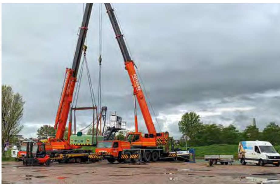
De kraan is van het schip gehaald vanwege een kapotte zwenkaandrijving.
