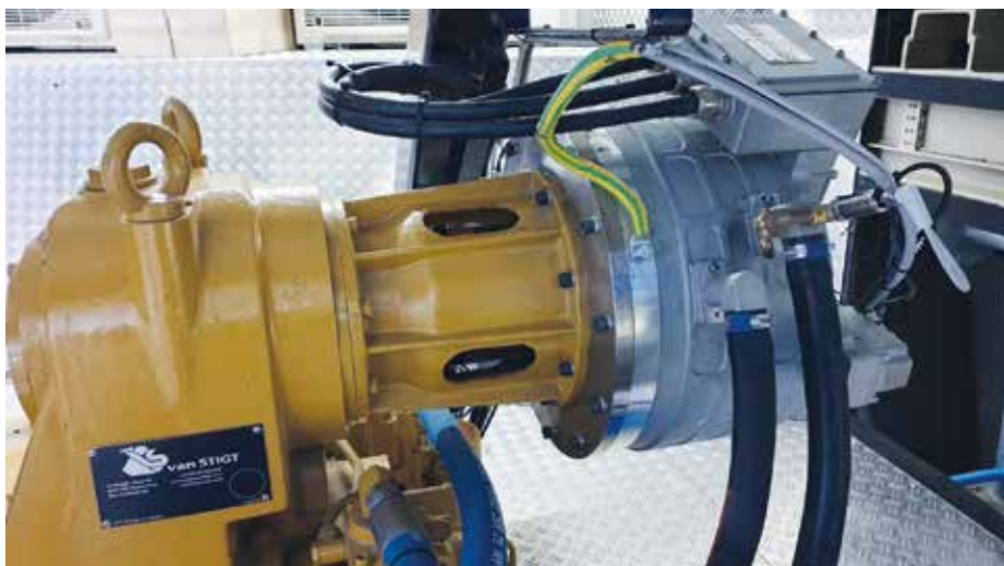
De nieuwste schepen zijn uitgerust met schroefasgeneratoren.
