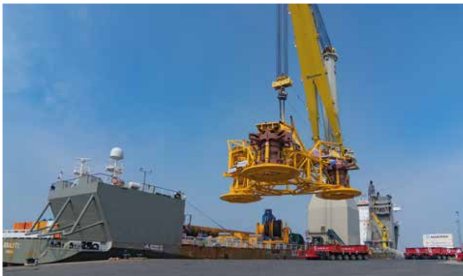
Laden van een drilling template bij Breman Offshore, bestemd voor de site van het offshore windpark in de baai van Saint-Brieuc, 16,3 kilometer uit de Franse kust.
