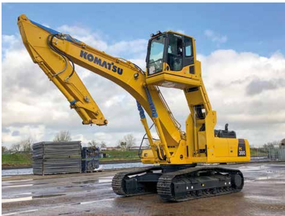
Een Komatsu-graafmachine met hydraulisch in hoogte verstelbare cabine, een specialisme van L. Timmerman & Zn.
