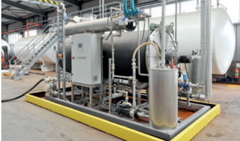
Vacuümverdampers voor de scheiding van bromidehoudende zouten en water.
