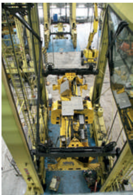
Het hijsblok in de straddle carrier waarmee de containers opgepakt worden
