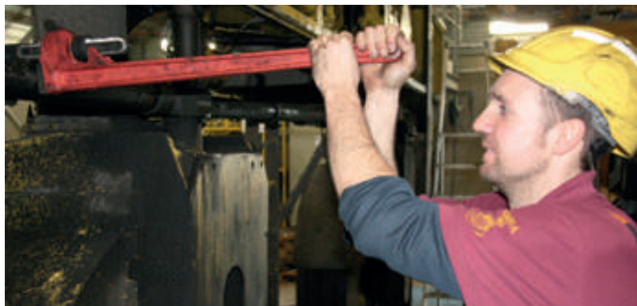
Kim draait aan de stuurstang voor de uitlijning van het rijwerk
