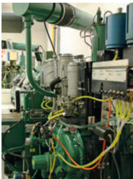
Motoren voor analyse van het octaangehalte, dit is een referentiewaarde voor de klopvastheid van benzine.
