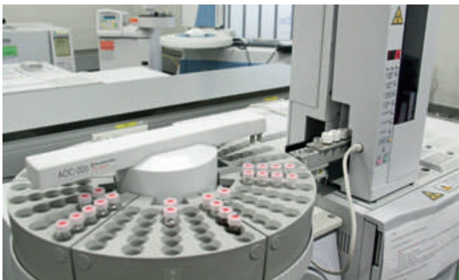
Autosampler voor geautomatiseerd injecteren van samples voor GC-MS (Gas Chromatography Mass Spectrometry).
