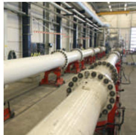
Leidingstraat van het gesloten circuit voor te testen klantmeters.
