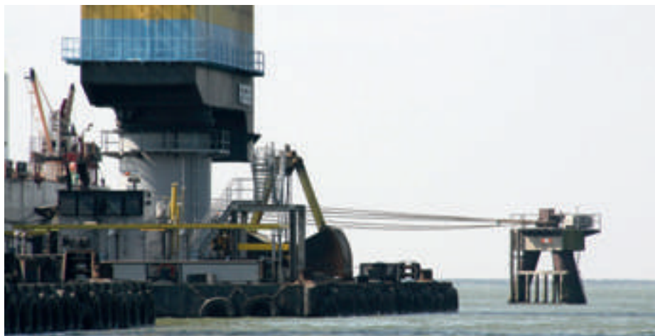
Een paal waartegen de boten worden afgemeerd om te lichten.
