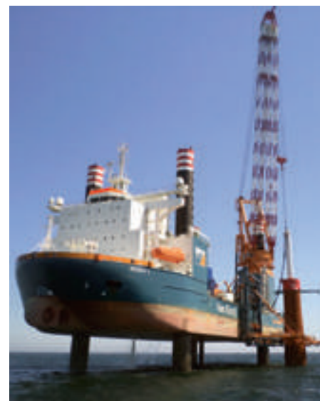
Installatie monopyle door Aeolus Van Oord
