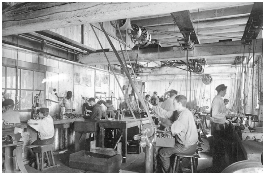
Vervaardigen van het metalen deel van de lampvoet in het begin van de vorige eeuw bij Philips in Middelburg.
