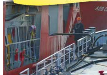
Overpompen van sludge naar chemicaliënboot Martens V voor vervoer naar de verwerkingsinstallatie in Vlissingen.
