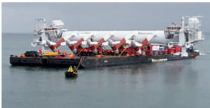
Getijdenturbines voor de Oosterschelde stormvloedkering.
