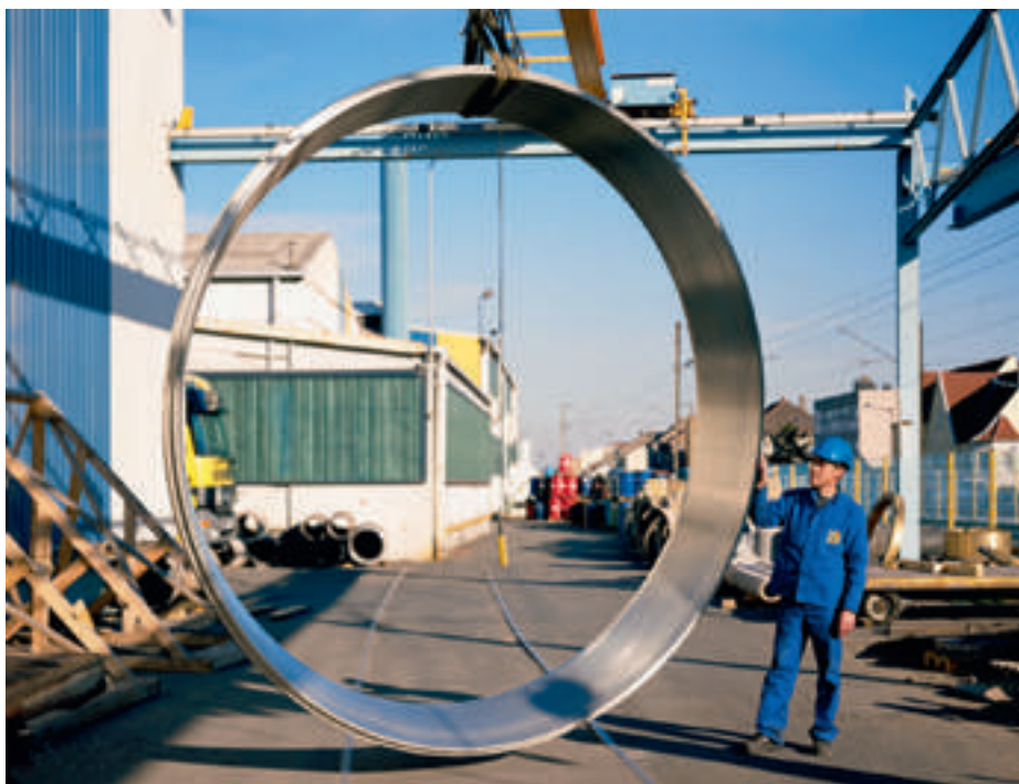
Ring voor turbinewiel in RVS duplex door LBI France gegoten en bewerkt
