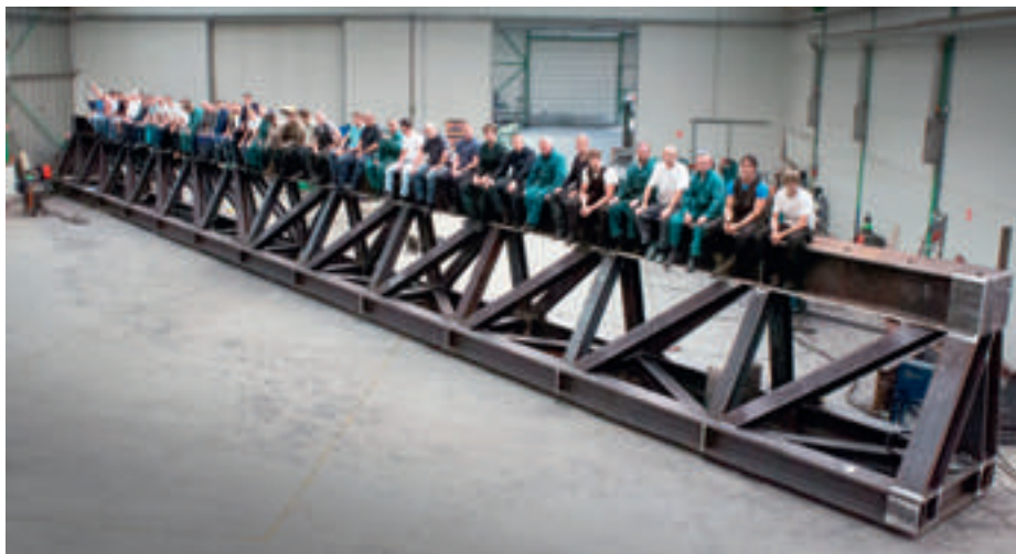
De binnenploeg poseert op een vakwerkspant van ruim 46 ton, wat nu dienst doet als kraanspant in Moerdijk
